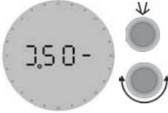
Режим (OFFS) позволяет выровнять показания в показанных терморегулятора и комнатном термометре. Если термометр показывает на  $1^{\circ}\text{C}$  больше, чем терморегулятор, с помощью этого режима может быть достигнута температура от  $-5.5^{\circ}\text{C}$  до  $+5.5^{\circ}\text{C}$ .
